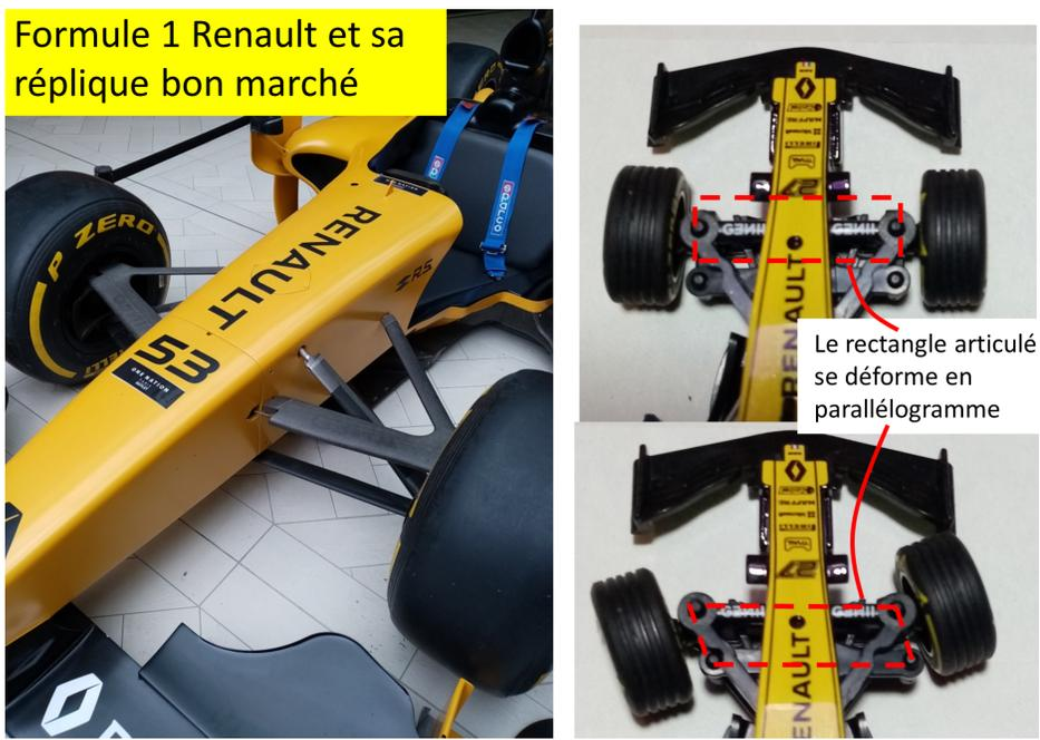
FIGURE 6 – Formule 1 Renault. L'original à gauche. Une copie bon marché au 1 : 24 à droite ; la direction comprend un rectangle articulé qui, en se pliant, se déforme en parallélogramme.
