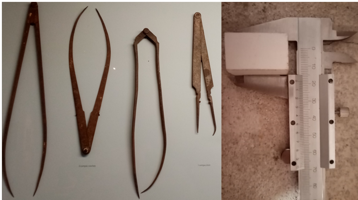
FIGURE 8 : À gauche : panoplie de compas (« étriers ») à l'usage des sculpteurs et des potiers. Musée Bourdelle, Paris. À droite : pied à coulisse précis au cinquantième de millimètre.
