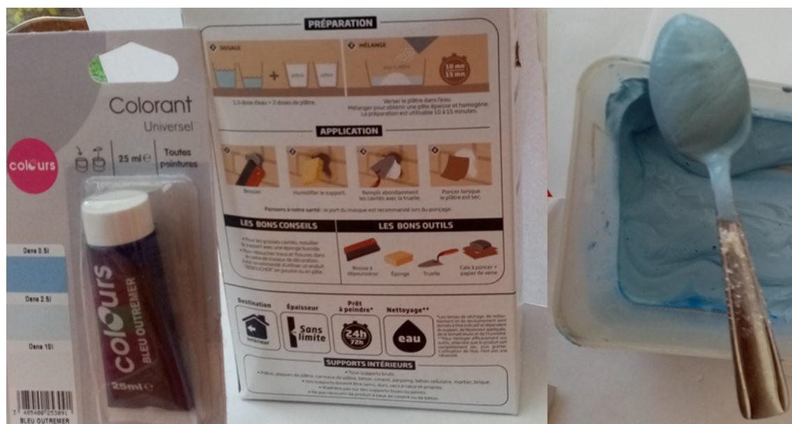
FIGURE 1 : Nuancier (à gauche), notice (au centre), et plâtre teinté(à droite) obtenu avec un ratio 1 : 100 : 133 en colorant : eau : plâtre.
