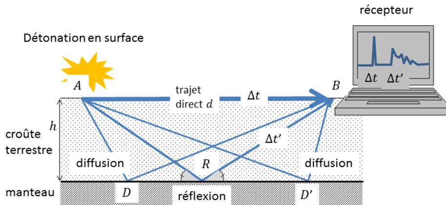
Figure 19 : profondeur d'une discontinuité ("MOHO" en géologie)
