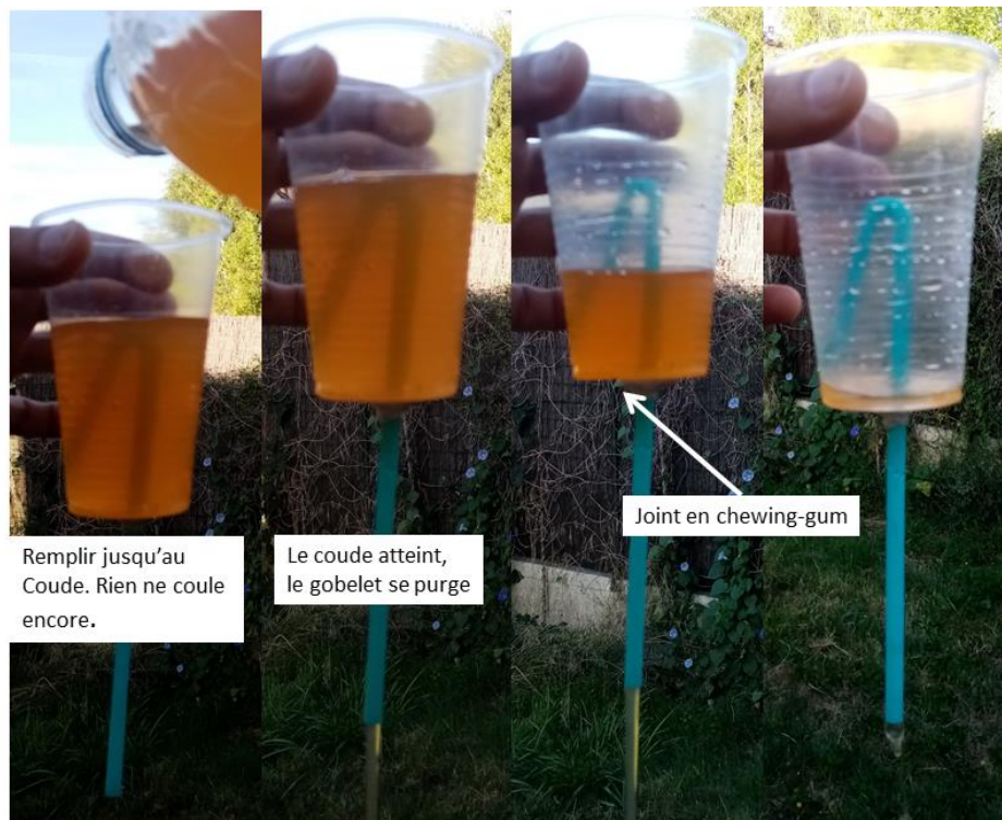
Figure 3 : Numéro de magie avec un gobelet de Pythagore (en fin de vidange à droite après avoir été rempli jusqu'au niveau du coude).
