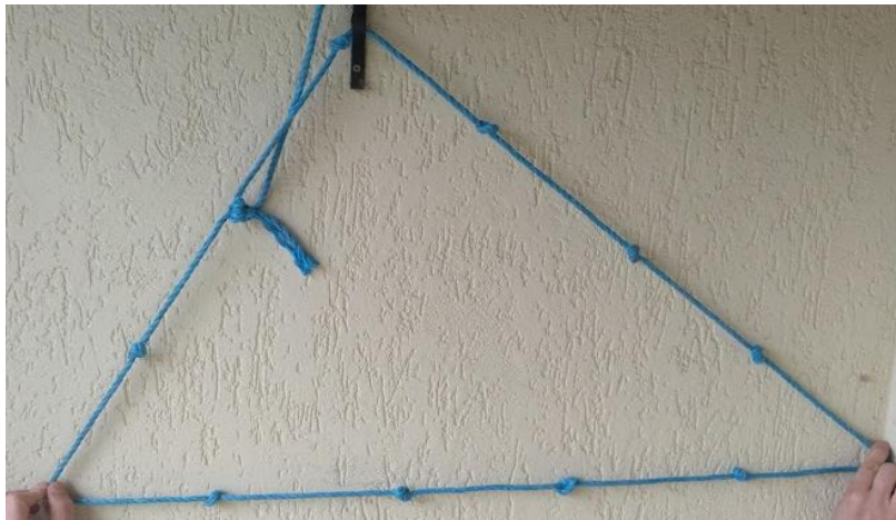
Figure 12 : Usage d'une corde à 13 nœuds.
