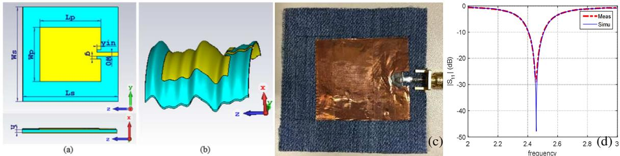
**Figure 4.4.** Antenne patch en jean : (a) plan, (b) courbé et froissé, (c) prototype plan, (d) coefficient de réflexion simulé et mesuré (cas planaire).
