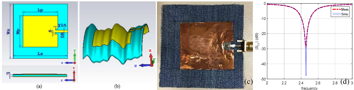
Figure 4.4. Antenne patch en jean : (a) plan, (b) courbé et froissé, (c) prototype plan, (d) coefficient de réflexion simulé et mesuré (cas planaire).
