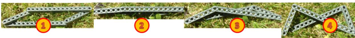
FIGURE 6 : Métamorphose d'un parallélogramme en contre-parallélogramme
