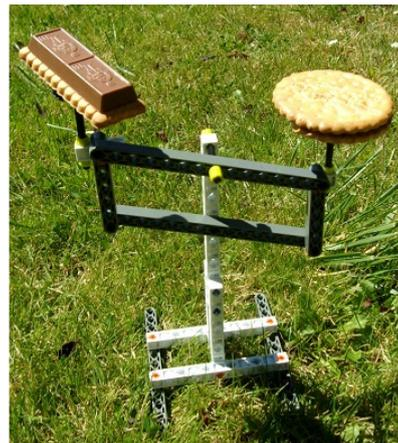
FIGURE 5 : conception et réalisation d'une balance de Roberval [1]
