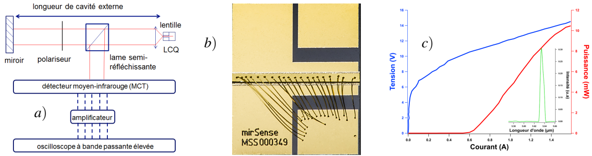
FIGURE 1 : Montage expérimental permettant conjointement d’appliquer une contre-réaction optique et d’analyser le signal (a) ; laser à cascades quantiques soudé à l’or-étain sur une embase et équipé de fils d’or pour l’alimentation (b) ; caractéristiques courant-tension et puissance-tension du laser lorsqu’il est alimenté à température ambiante et avec un rapport cyclique de 3% (c). L’insert montre le spectre du LCQ.
